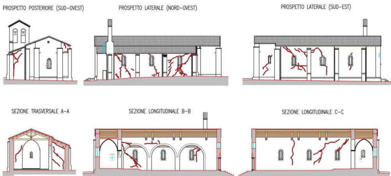
Schematizzazione del QUADRO FESSURATIVO
