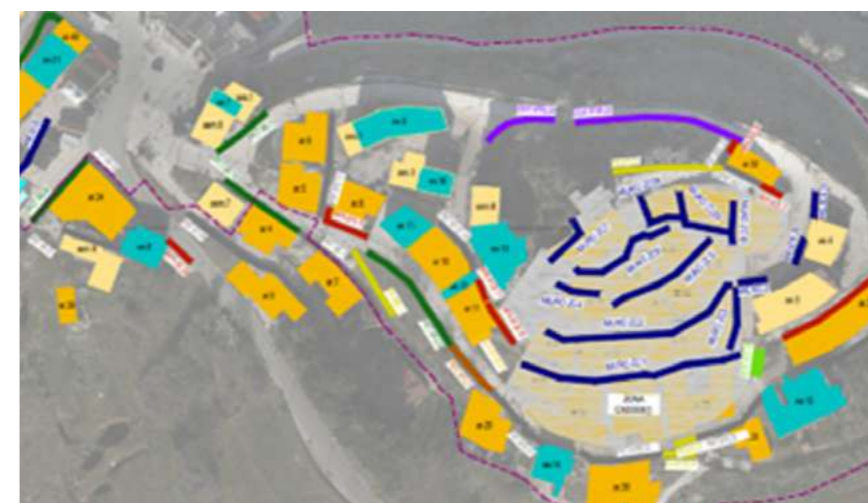
Figura 63. – Interventi di terrazzamento dei terreni e realizzazione dei sottoservizi: 1° contratto applicativo
