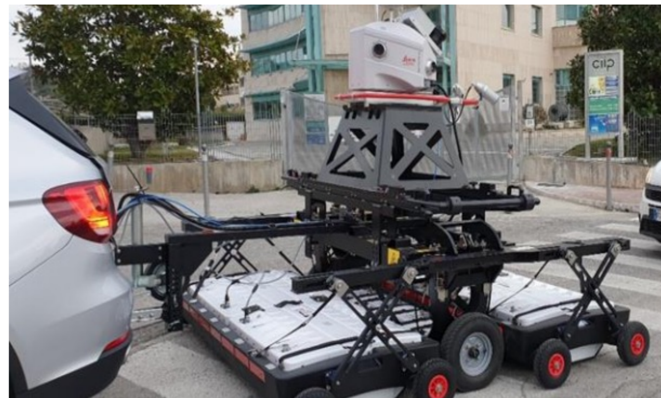
Figura 77. – Strumentazione per il rilievo scanner
