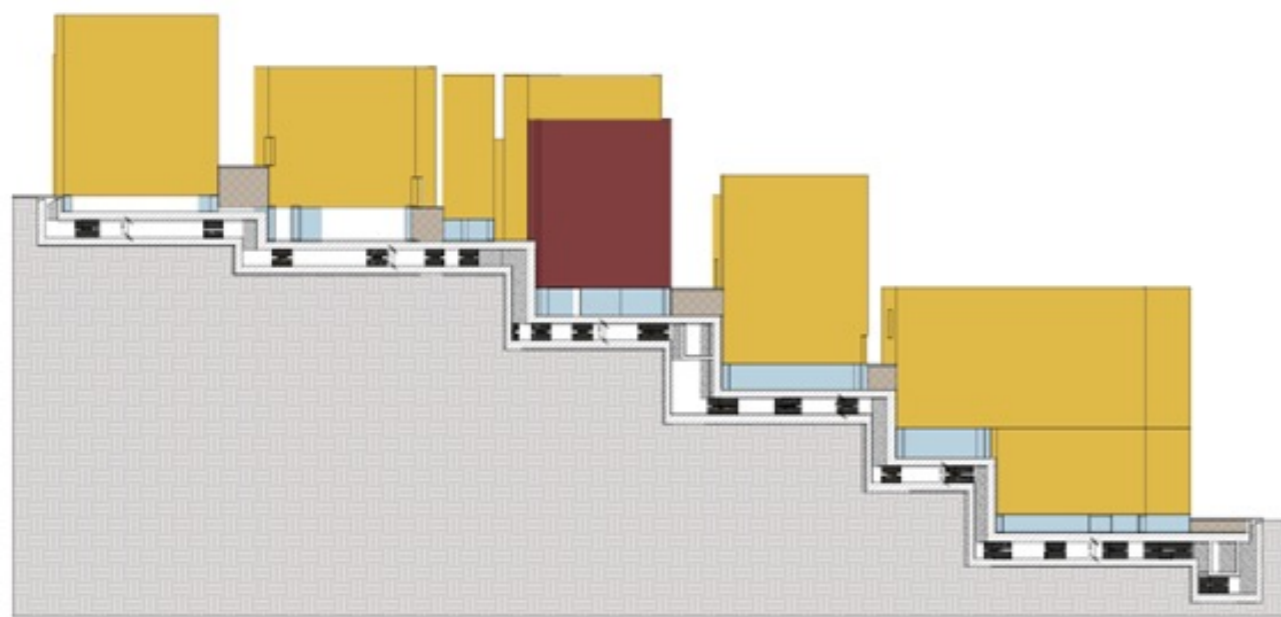
Figura 65. – Interventi di terrazzamento dei terreni e realizzazione dei sottoservizi: 1° contratto applicativo
