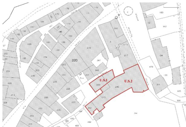
Fig. 8 – Estratto catastale con il riferimento della distribuzione delle unità strutturali.
