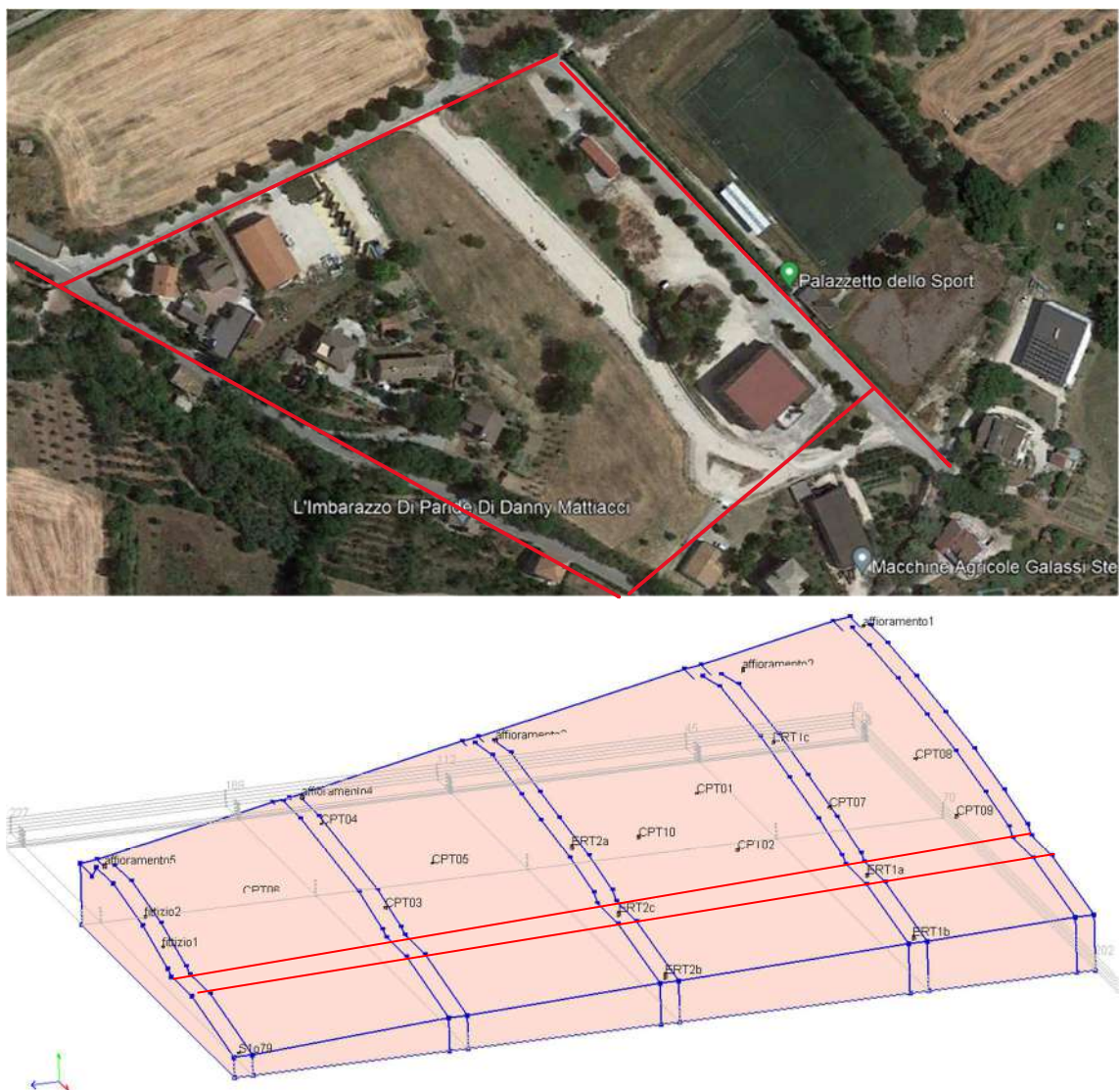
Figura 5.3. In alto: perimetro dell'area effettivamente modellata; in basso: vista 3D dell'equivalente modello a macro-elementi finiti con ubicazione delle indagini (successivamente discretizzato nella versione finale vista in figura 5.1); le linee rosse ricalcano la strada posta a valle dell'area (non si è tenuto conto della sua variazione di larghezza) consentendo una migliore lettura della posizione di quest'ultima
