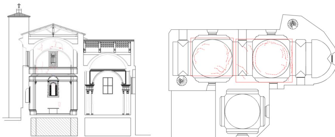
La struttura verticale presenta una muratura mista di laterizi e pietra dello spessore di circa 130 cm al piano interrato e di 70 cm al piano dell'aula liturgica. L'altezza massima all'estradosso della volta misura 13 metri. La tipologia costruttiva è costituita da due paramenti, uno interno ed uno esterno, con mattoni e
