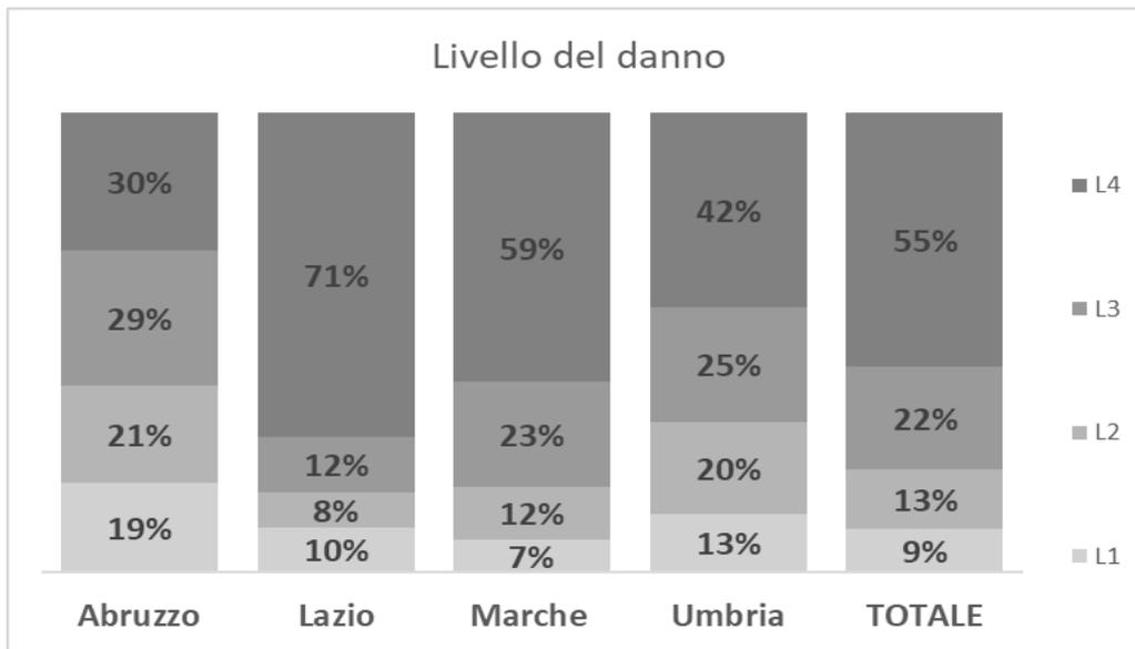
Tutti gli edifici per i quali sono stati prenotati i contributi hanno danni gravi, e nella maggior parte dei casi gravissimi. Quelli classificati con livello operativo L4, che prevede quasi sempre la demolizione e la successiva ricostruzione ex novo, sono 21.690. Quelli classificati con L3 sono 8.765, gli L2 5.114 e quelli definiti come L1 3.644.
